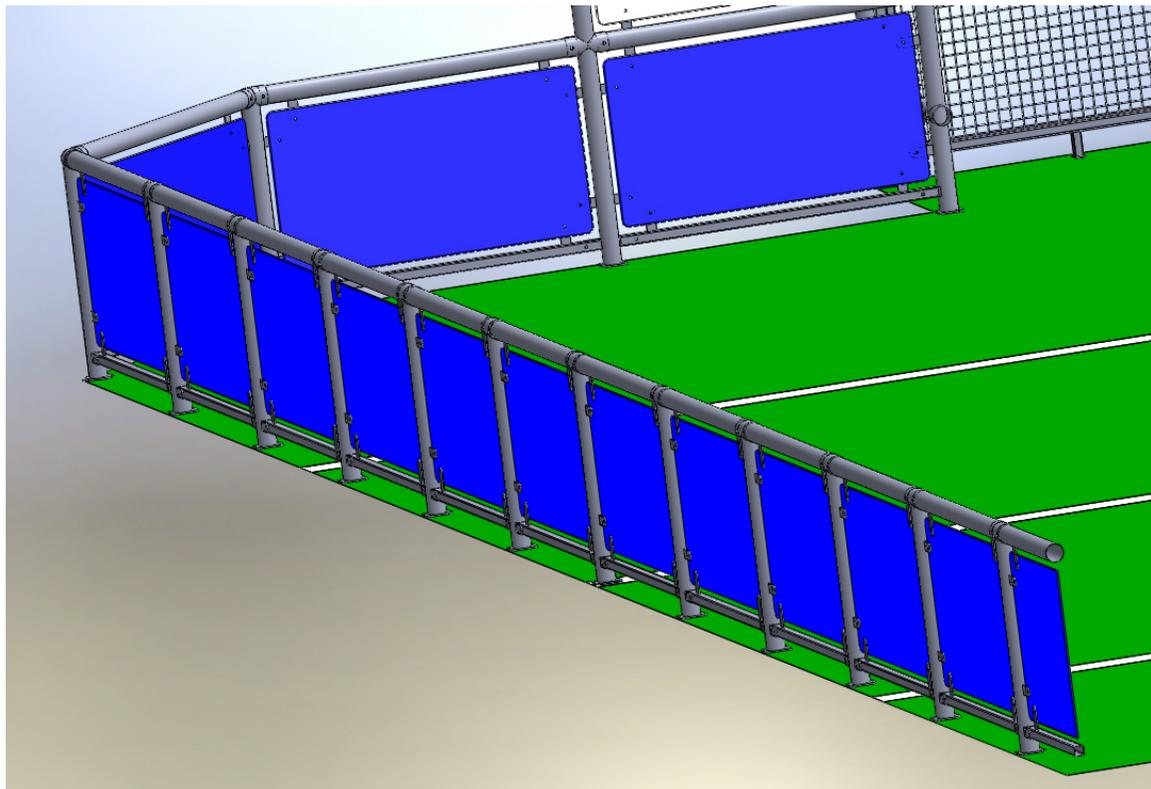
Acero de alta resistencia, sometido a un tratamiento de limpieza, desengrasado y pintura al polvo desarrollada para objetos instalados a la intemperie.
